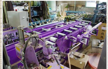
【施 工】畳の大きさは一部屋づつ異なります。製造ラインはコンピュータ制御されており、計測器で採寸したデータを入力し、一枚一枚丁寧に仕上げます。他にも古畳の引き取りや、畳の殺菌乾燥など、何でもご相談ください。
